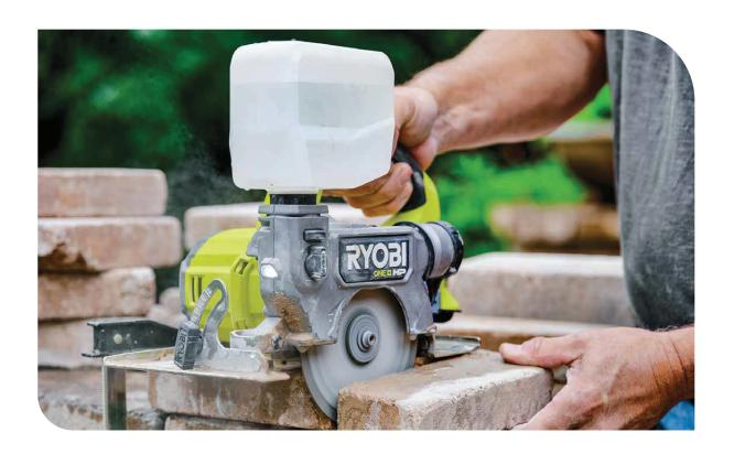
RYOBI 18伏特ONE+ HP無碳刷5吋攜帶式陶瓷/瓷磚鋸採用HP技術通過無碳刷馬達、先進的電子設計和高性能的鋰技術提供提升動力、運行時間、耐用性和速度。這款鋸可以有效地切割瓷磚、磚塊、石材和玻璃等,每次充電可切割可超過100呎,能夠有效率地完成大量切割工作。這款鋸配備了領先業界的20.5安士水箱以及水流速率調節控制以達致減少灰塵效果,12呎供水軟管可提供無限水源供應,適合大型項目使用。能夠接駁吸塵機系統兼容1-1/4吋和1-7/8吋的排氣口,並內置LED燈提高了工作可見範圍及能見度。
