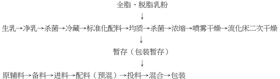
干湿法复合工艺流程应包括除终产品包装外的全部湿法工艺流程和相应的干法工艺流程。
